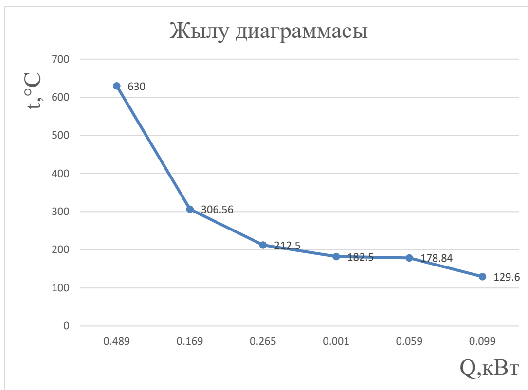
5 - сурет – Қазандық утилизатордың жылу диаграммасы
